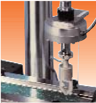
▲ Испытания печатных плат на отслаивание
