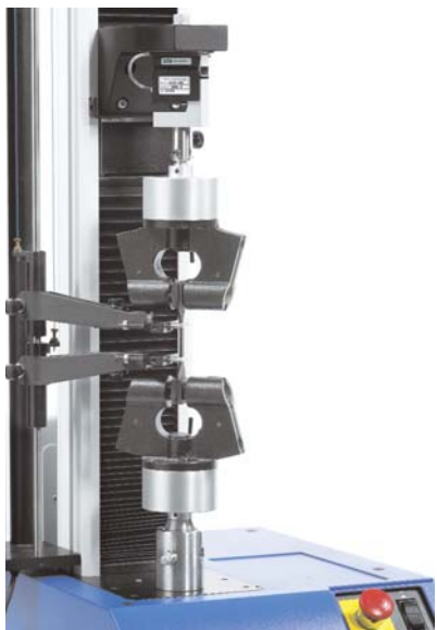
▲ ASTM D 412 (испытание резинового образца в форме гантели)
