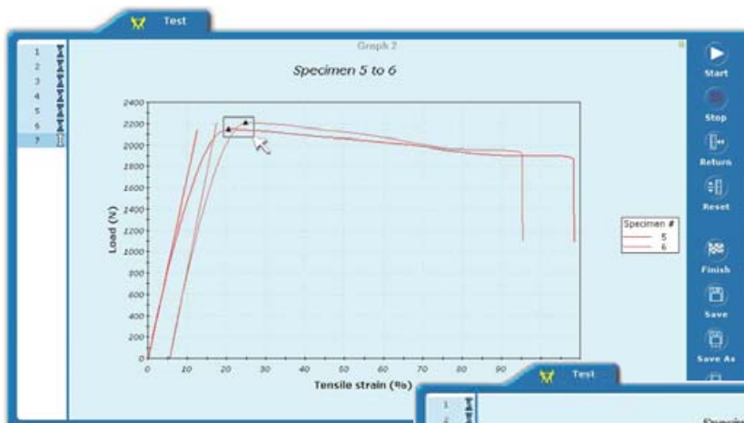
▲ Укрупненное изображение фрагментов графиков по испытаниям 1 и 2, на которых отмечаются пики
