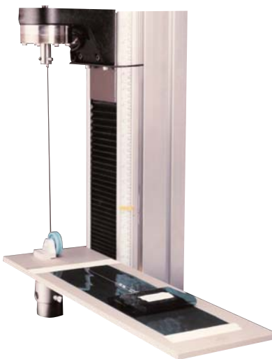
▲ ASTM D 1894 испытания на определение коэффициента трения
